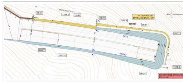
Figura 17.- Planta de excavación del Portal Sur (Tskere).
