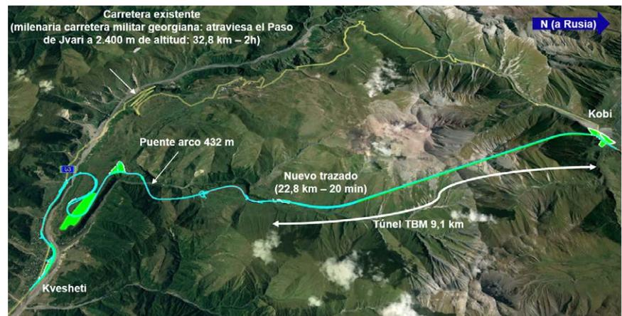
Figura 2.- Trazado del túnel de Gudauri.
