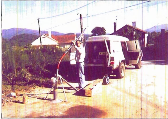
Foto 2.- Introducción de la sonda sónica en uno de los sondeos.
