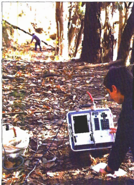
Foto 5.- Equipo utilizado para la sismica de refracción.
