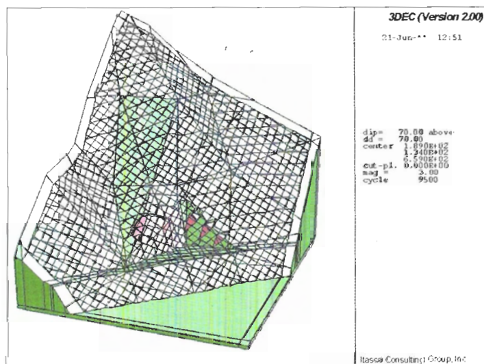
Fig. 4.- Mecanismo de rotura obtenido simulando una geometría realista y 3 familias de juntas.
