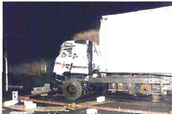
Foto 5.- Camión utilizado en los ensayos de incendio realizados en el Túnel del Mont Blanc, durante 2.001. (Cortesía: A. Voetzel).
